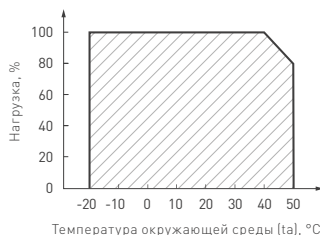
Рис. 2. Максимальная допустимая нагрузка, % от мощности источника.
